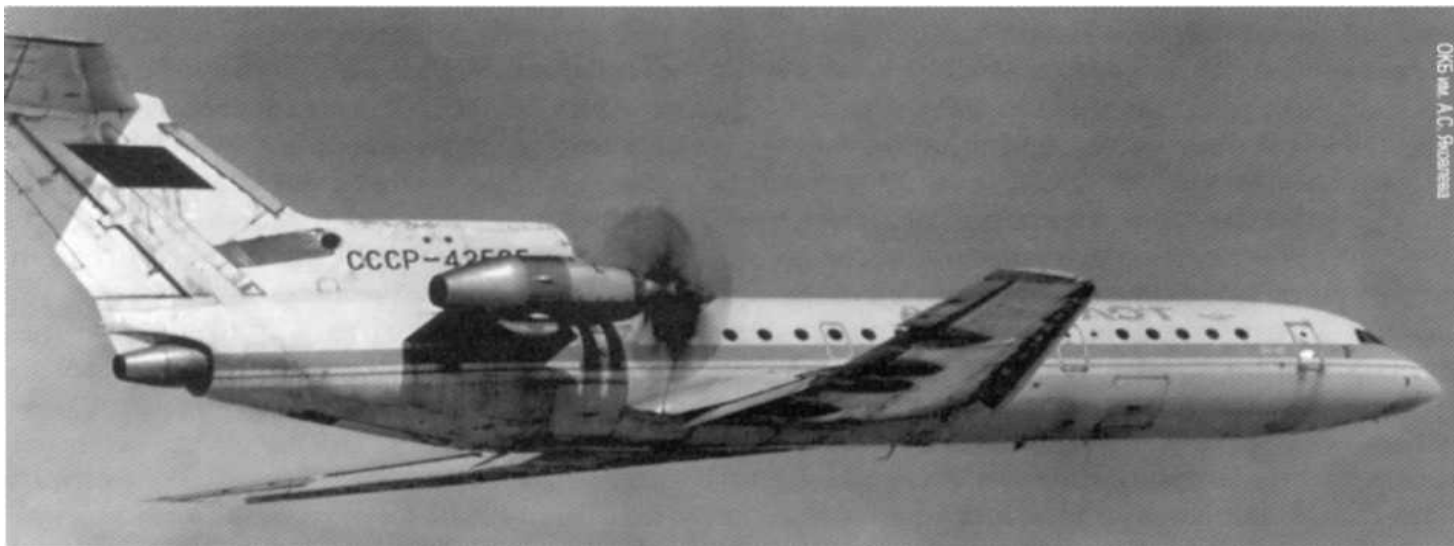
Летающая лаборатория Як-42ЛЛ с двигателем Д-236
